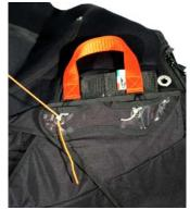
Führen Sie die metallischen Splinte in die elastischen Schlaufen unter der transparenten Abdeckung. Die Leine, die zur Hilfe genommen wurde, muss nun unbedingt entfernt werden. Ziehen Sie die Leine langsam heraus, um die elastischen Schlaufen nicht durch zu hohe Reibung zu beschädigen. Am Ende wird der Griff unter der elastischen Abdeckung eingesetzt.
